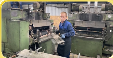
Шлифовка и полировка клинков с 2-х сторон (для придания гладкости и блеска)
